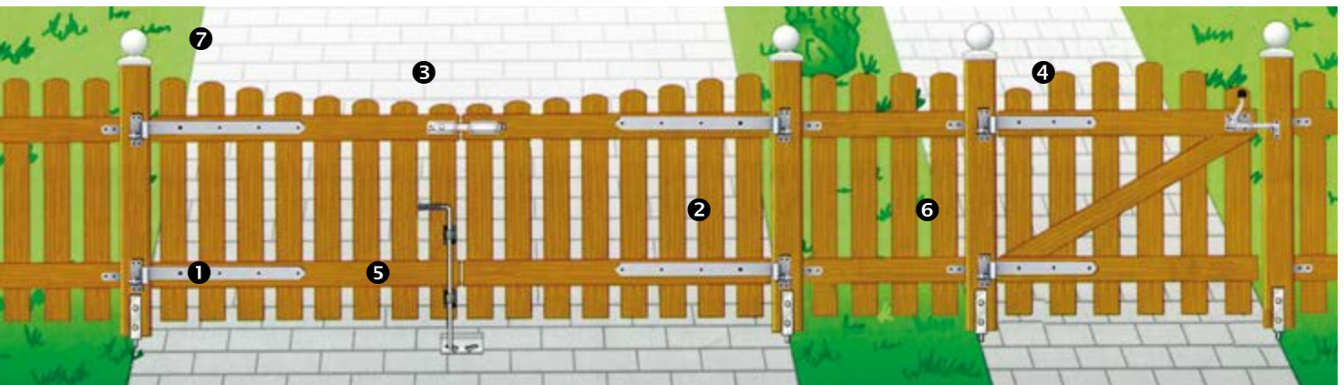
1 Pfostenanker 2 Elementhalter 3 Überwurf 4 Torfalle 5 Bodenschieber 6 Ladenband 7 Pfostenkappe
